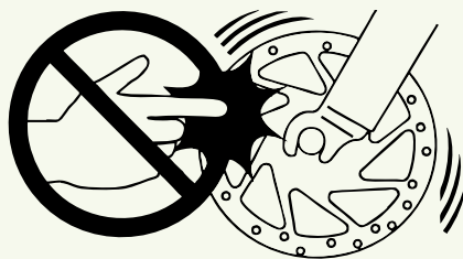
Fig. 38. Rør ikke ved bremseskiverne
