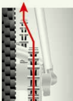
Abb. 46. Zahnriemen und Kettenblatt nichtkorrekt ausgerichtet
