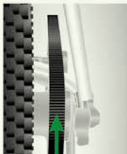
Bild 45. Korrekt inriktning för @Gates
