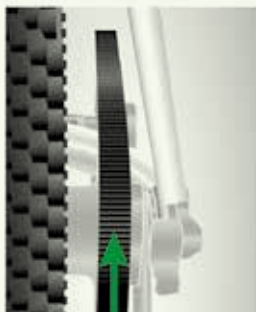
Abb. 45. Korrekte Ausrichtung mit Zahnriemen
