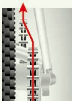
Bild 46. Dreven är inte korrekt inriktade för @Gates
