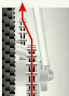
Fig. 46. Les pignons ne sont pas alignés correctement sur la courroie @Gates
