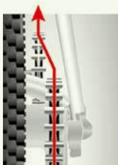
Fig. 46. Tandhjul er ikke justeret korrekt @Gates
